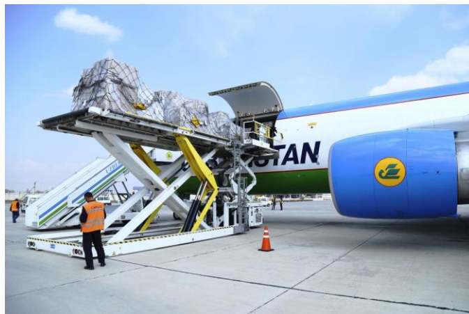
Рисунок 2 – Переоборудованный из пассажирского в грузовой самолёт B767-300 ER
