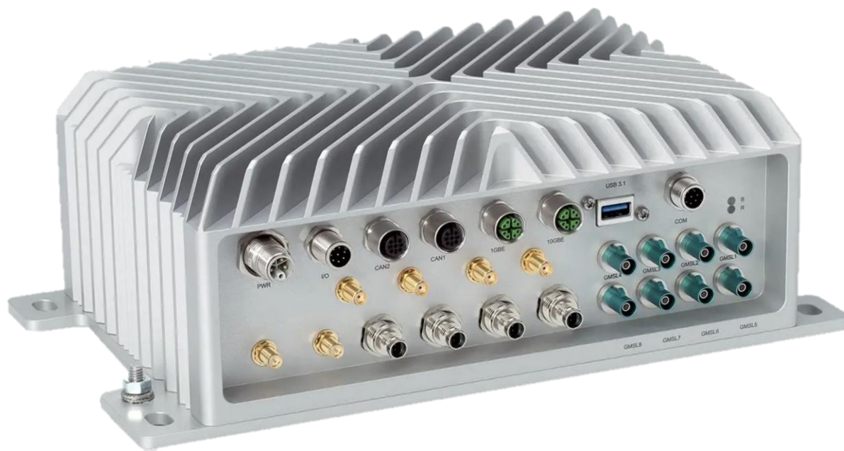
Рисунок 3 – Jetson Orin NX в промышленном корпусе.
