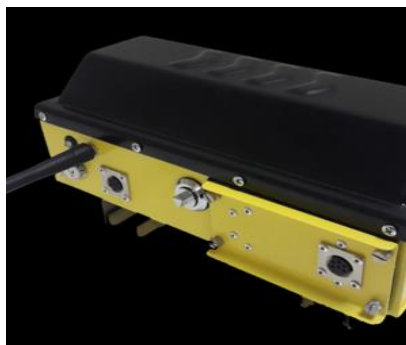
Рисунок 4 – Датчик обнаружения подвижного состава с радиостанцией (блок ДОП-РСДОП)
