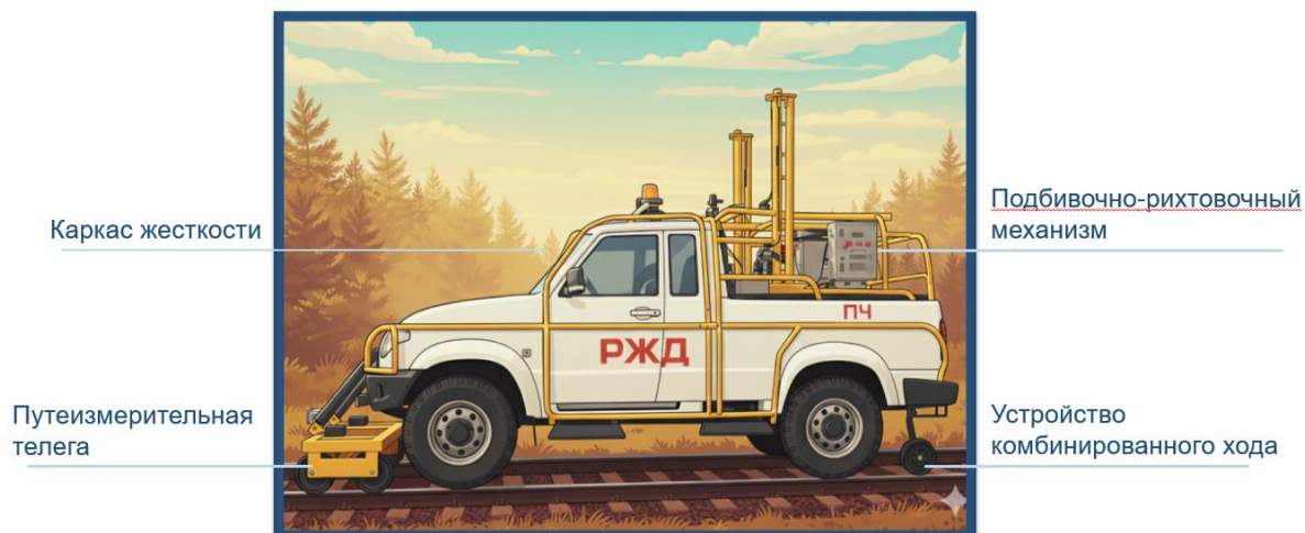
Рисунок 2 – Автомобиль на железнодорожном ходу с габаритными размерами автомобиля УАЗ «ПРОФИ»
