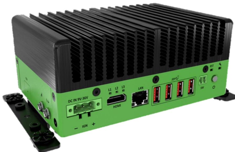
Рисунок 1 – Jetson Orin Nano Super в промышленном корпусе. (Источник изображения: https://premioinc.com/products/jco-1000-orn-a_1l )
