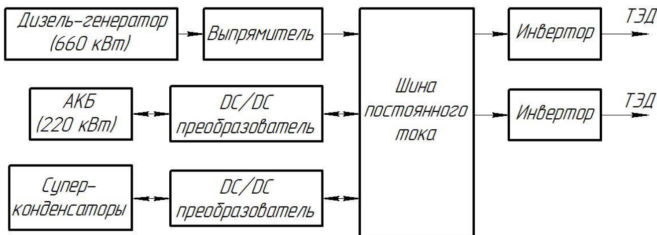
Рисунок 2 – Структурная схема гибридной силовой установки тепловоза ТЭМ9Н
