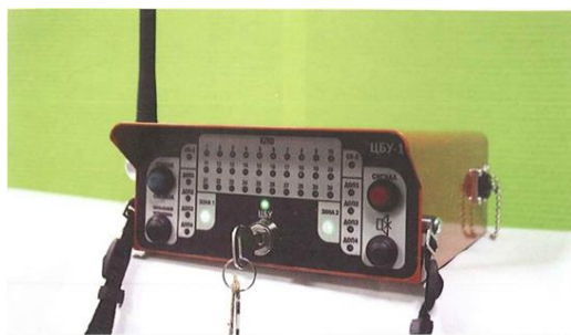
Рисунок 2 – Центральный блок управления с радиостанцией (ЦБУ)
