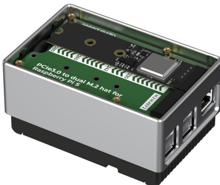
Рисунок 4 – Одноплатный компьютер Raspberry Pi 5 - 8GB и модуль Nailo-8 AI (Источник изображения: https://www.antratek.com/recomputer-ai-r2130-12 )
