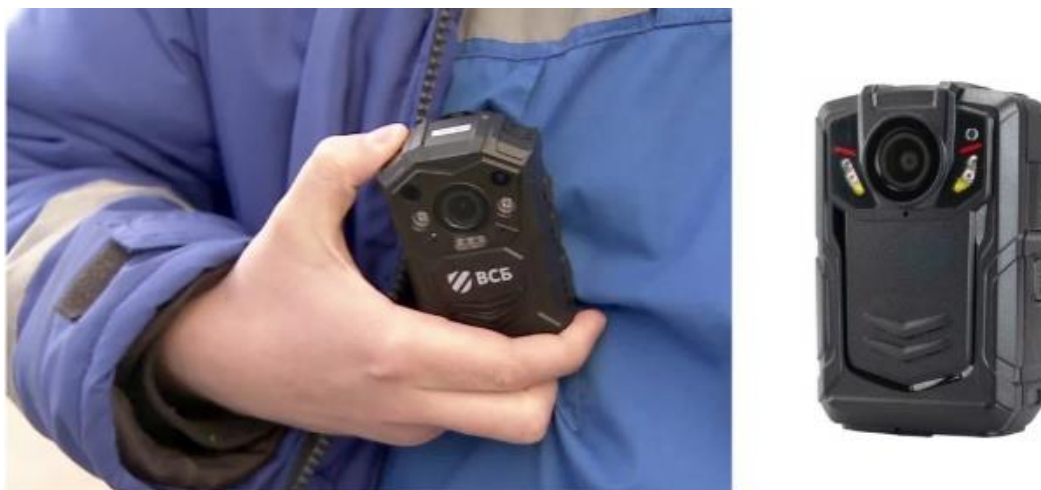
Рисунок 1 – Нагрудный видеорегистратор для дистанционного коммерческого и технического осмотра вагонов
